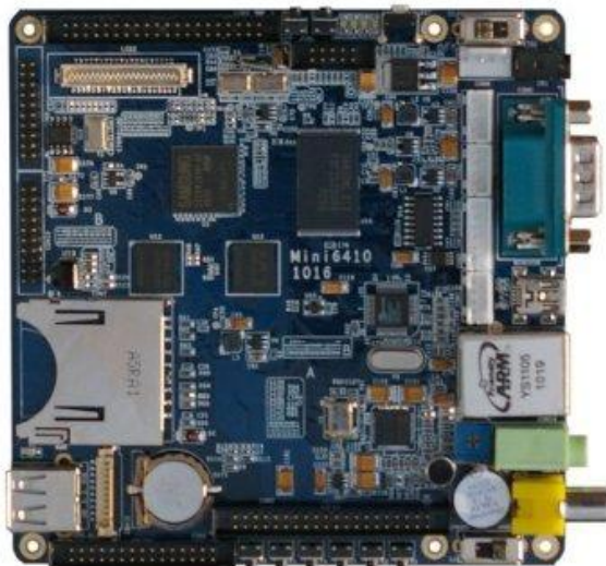
Fig1. MINI 6410 Development board
